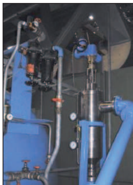
图 2: 运行中的多级 Z 型阀门
